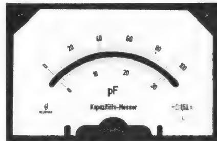
Bild 13. In Kapazitäten geeichte Skala des Meßwerkes
